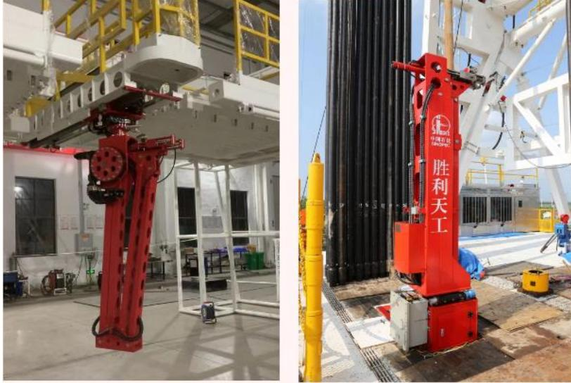
▲ “勝利天工” DREAM-II 鑽井管柱自動化作業系統
